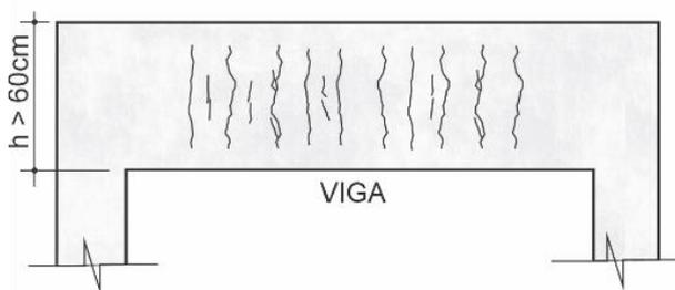
Durante a vistoria de manutenção de um edifício, constatou-se a existência de fissuras verticais ao longo de toda a extensão das vigas de concreto armado que possuíam altura superior a 60 cm. A provável causa desta patologia está associada
